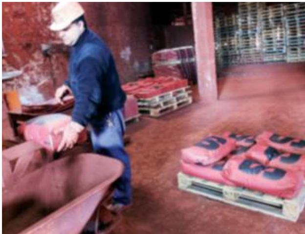
**EL ENVASE.** Un gran molino pulveriza la piedra y, por una canalización, llega a una sacadora. En este caso el operario envuelve sacos de 25 kilos pero los hay de hasta 1.300.
